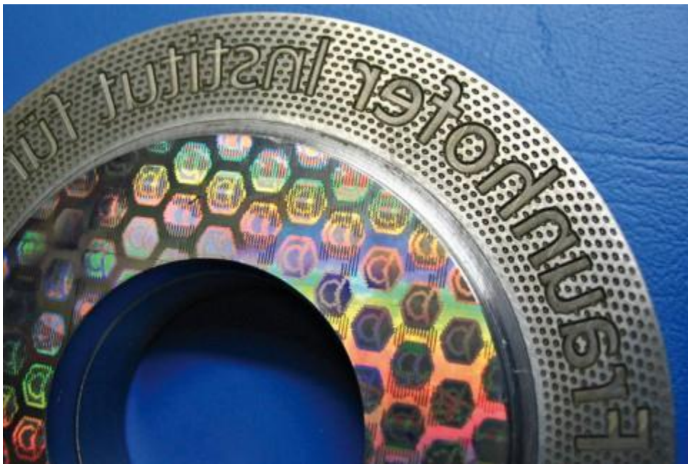
Foto: Fraunhofer - Produktpiraterie verursacht weltweit Schäden in Milliardenhöhe: Eine Kombination von sichtbaren und unsichtbaren Strukturen schützt wirkungsvoll vor Fälschungen. Mit Sprengprägen wird das auf wirtschaftliche Weise möglich auch für Massenware.
